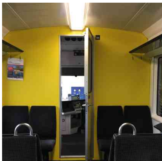
Innenraum der «Seconda» (rechts) mit den neuen LCC-Rohrleuchten T8 (4000K, Detail links). (Bilder: Daniel Geissmann)
