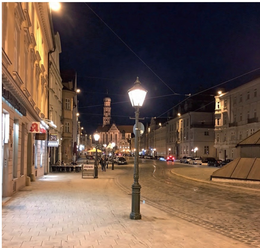
LCC ist ein optimaler Ersatz für Entladungslampen: Kürzlich wurde in der Stadt Augsburg die Beleuchtung der Haupt-Prachtstrasse anstelle von Natriumdampf-Lampen mit LCC-Retrofitlampen ausgerüstet. (Bild: Markus Frutig, ET Licht)
